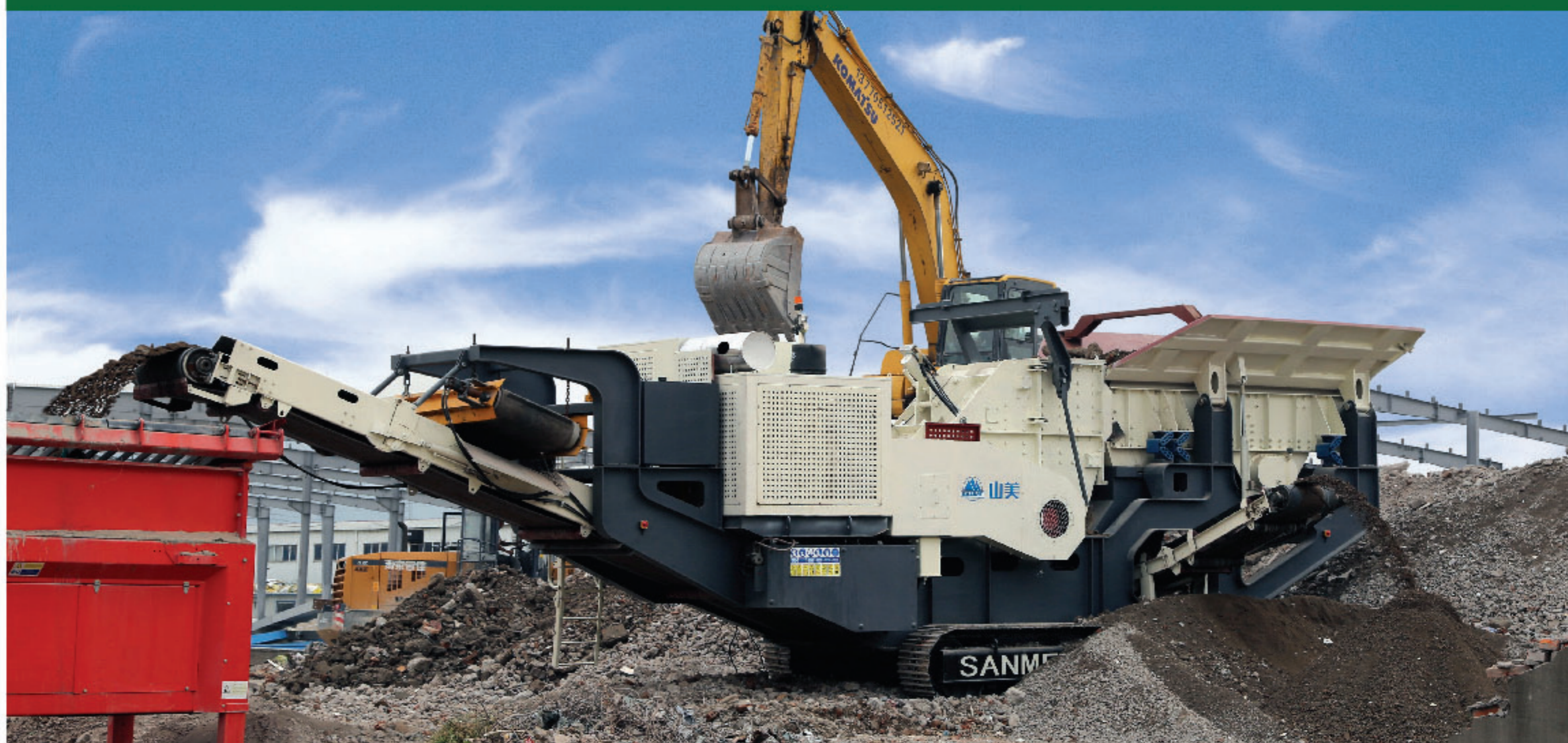
江苏南京 100 吨 / 小时 履带移动式建筑固废资源化利用生产线
